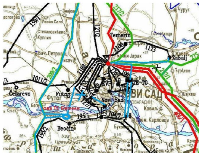
Слика 11.7 - Сагледавано стање у 110 kV мрежи на подручју града Новог Сада 2023. године (плаве линије – нови 110 kV водови, односно постојећи водови 220 kV који ће радити под 110 kV напоном)
